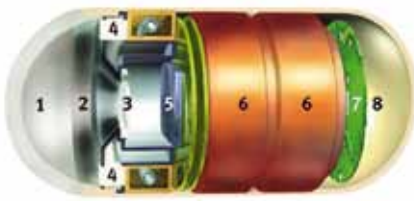
Figur 2. Videokapseln (Given Imaging) i genomskärning: 1= optisk kupol; 2= linsfäste; 3= lins; 4= ljusdioder; 5= bildsensor; 6= batterier; 7= radiosändare; 8= antenn.
