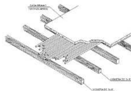
TECHO DE SACRISTIA CON VIGAS DE INTERCALADAS DE SECCIÓN RECTANGULAR Y CUADRADA ESC: 1/25
