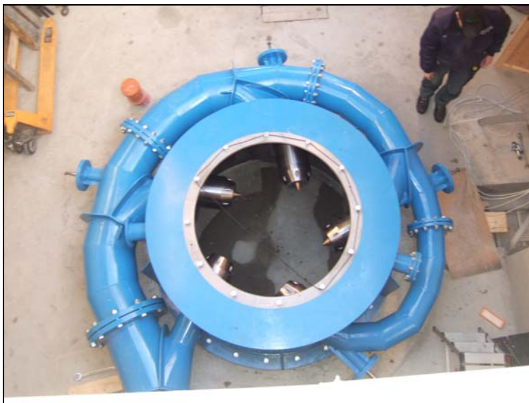
Figur 5: Del av en peltonturbin med fem ventiler
